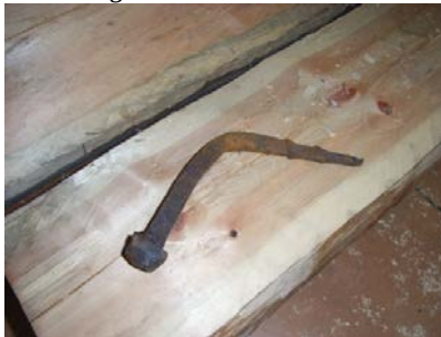
Smidd mothakespiker med kvadratisk tverrsnitt og pyramidehode. Svensgården rom 4C101
