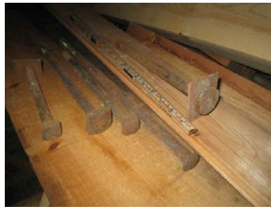
Skrubolter, 4 stykk, med fire typer hoder. (til venstre en fransk skrue): Sekskantet, rundt flatt, firkantet, svakt pyramideformet. Alder? Lagret i Sandviksboder 23. Samlet fra bodene 15-17, 20 og 23-24.
