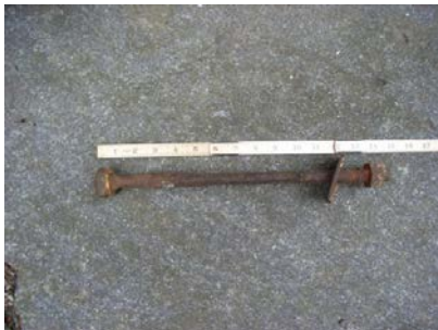
Skrubolt med smidd eller påsveiset pyramidehode i en ende og sekskantmutter i den andre enden. Antas derfor å være fra 1920-tallet eller nyere.
