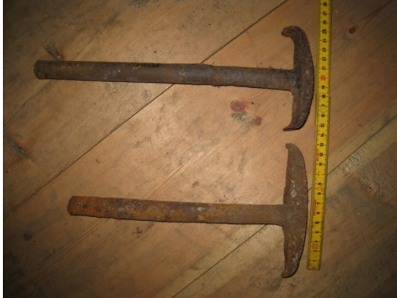
Klobolter funnet i Svensgården rom 4C101. En klo funnet med mutter. Fotodokumentasjon for kopiering i bygning 5B.
