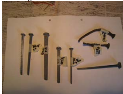
Diverse spiker, fra venstre: Ny klipt, blank. Deretter 4 nye galvaniserte. Til høyre 3 gamle, rustne, ubehandlede spiker.
