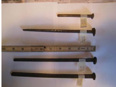
Klipte spiker, ubrukte. Funnet i en løe i Sogn. Fra Chr. Spigerverk.
