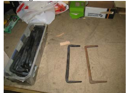
Gammel, rusten bindhake til høyre. Nye bindhaker fra Dokken kunstmie til venstre. De nye er linoljebrent. (Blanding av linolje og motorolje)
