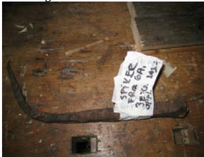
Smidd mothakespiker med "flatet" hode to sider. Hjortegården, 6a.
