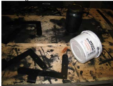
Holmedalsgården. Vindusbeslag. Jenbeskyttelse med Graphite-pulver og kokt linolje.
