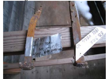
Mothakespiker med kvadratisk tverrsnitt og pyramidehode og rektangulært tverrsnitt med flatt hode. Svensgården 4C og 5B.
