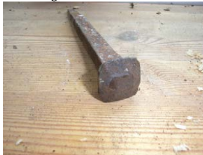
Smidd spiker uten mothaker med "påsveiset" hode. Sandviksboder 20.
